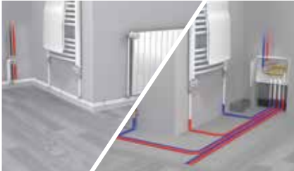
Chauffage apparent Chauffage encastré
